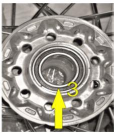
Установите переднее колесо в вилку и просуньте ось колеса [4] через зажимы. Накрутите гайку [2] на ось. Затяните зажимные болты [3] с правой стороны вилки, чтобы не проворачивалась ось. Затяните гайку [2] на оси с моментом (40 Нм).
