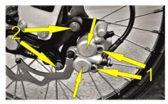
Установите тормозные колодки в суппорт и зафиксируйте их направляющими штифтами [1]. Тормозные колодки должны встать в свои пазы, чтобы между ними прошел тормозной диск. Установите тормозной суппорт вместе с кронштейном на свое место. Затяните болты [2] с моментом 25 Hm + Loctite 243.
