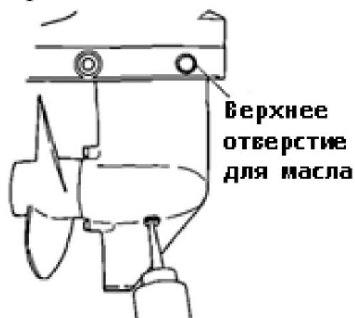
3. Вверните верхнюю пробку, затем, вытащив горловину тубика из отверстия нижней пробки, заверните ее на место.
